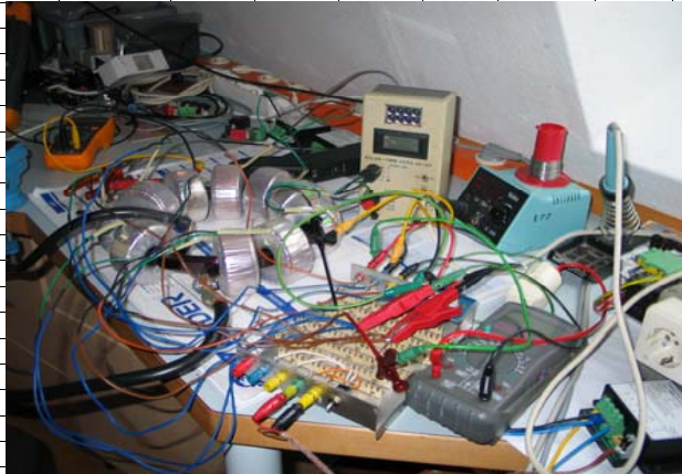
Trafotopf-Stromwandler-test-01.bmp, siehe Trafotopfbild, mit 6 gespeisten, 3 gebr. u. einem offenen Wandlertrafo, A= U sek., B = I sek.
