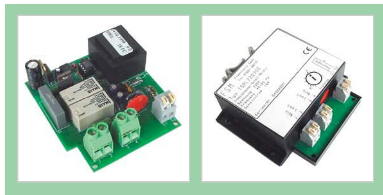
Bild 6: TSR für 400 V, 32 A, zum Einschalt-Stromstoß-freien Schalten von Einphasentrafos als Platine zum Einbau in Geräte (li.) und TSR für 230 V, 16 A, im Gehäuse zum Aufrasten auf die Hutschiene oder zur Wandbefestigung (re.)
